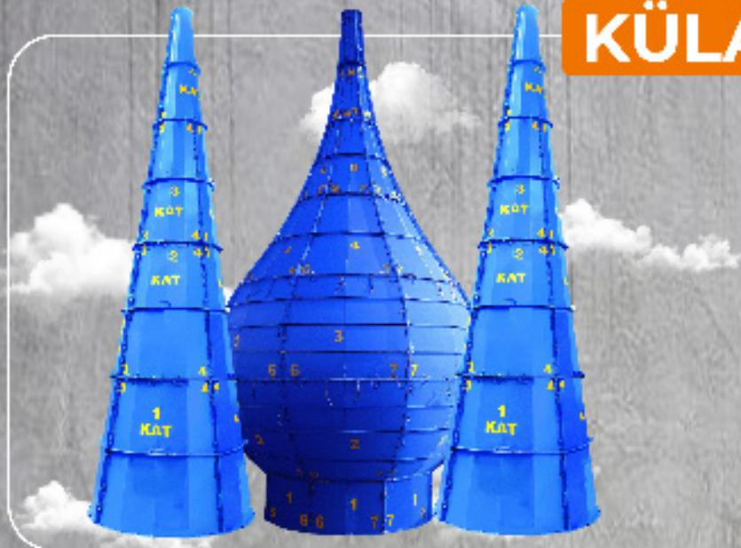
Betonarme minare kılıfları imalatı için kullanılan külah kalıplarında projede istenilen form 3 boyutlu teknik çizimi ile oluşturulur. Yatay ve dikdörtgen parçaların ayrı olarak 3 boyutlu şablonlar oluşturulup bu aşamada form ve birleşme detayları konularak sıkıştırılır. Ardından rastarlanan gibi külah parçaları imal edilir. Üretilen parçalar boyaları sayesinde hafif olur ve kolay kurulum için numaralandırılır.
