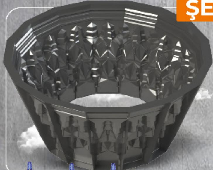
Mimari için evren ölçümü bulmak konusunu olusturmak için kullanılan kalıbın şerifi lehbi adı verilir. Bu konumun cephe yüzeyi genelde mukarnas gibi gölgelişsel ve dini motiflerle süslenmiştir. Betonarme minare inşaatında kullanıacak şerefe kalıbı uygula mak modelle göre eş parçalara bölünür.
